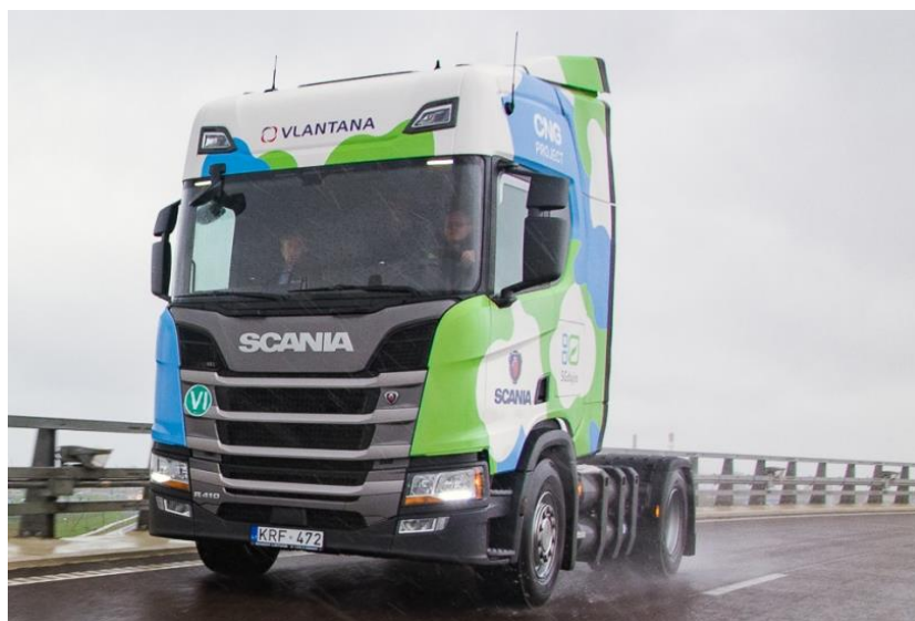
Figur 3. Scania R410 med en 13-liters gasmotor testas av litauiska Vlantana.
